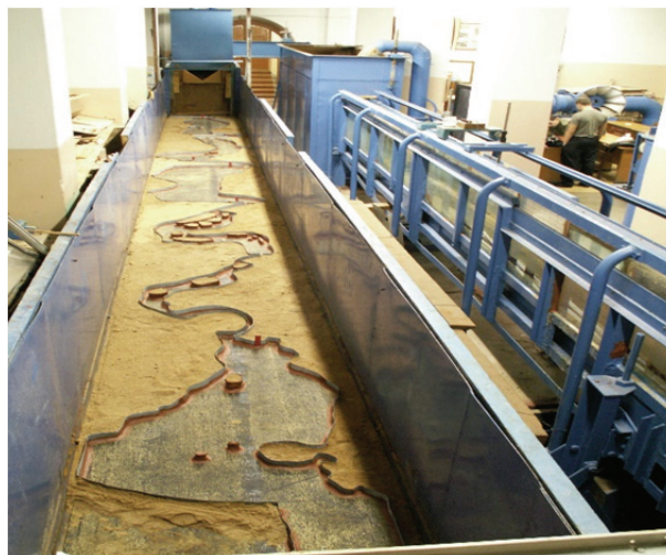
Рис. 2. Гидравлический лоток с моделями водохранилищ
