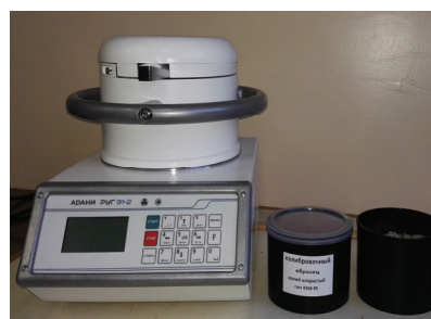
Рис. 2. Общий вид гамма-радиометра РУГ-91-2
