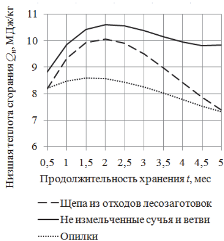
Рис. 3. Влияние продолжительности хранения основных видов древесного топлива на величину их низшей теплоты сгорания
