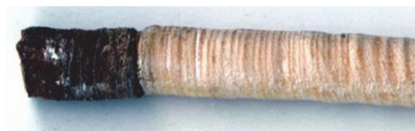
Рис. 3. Фотография керны при измерении годичного радиального прироста
