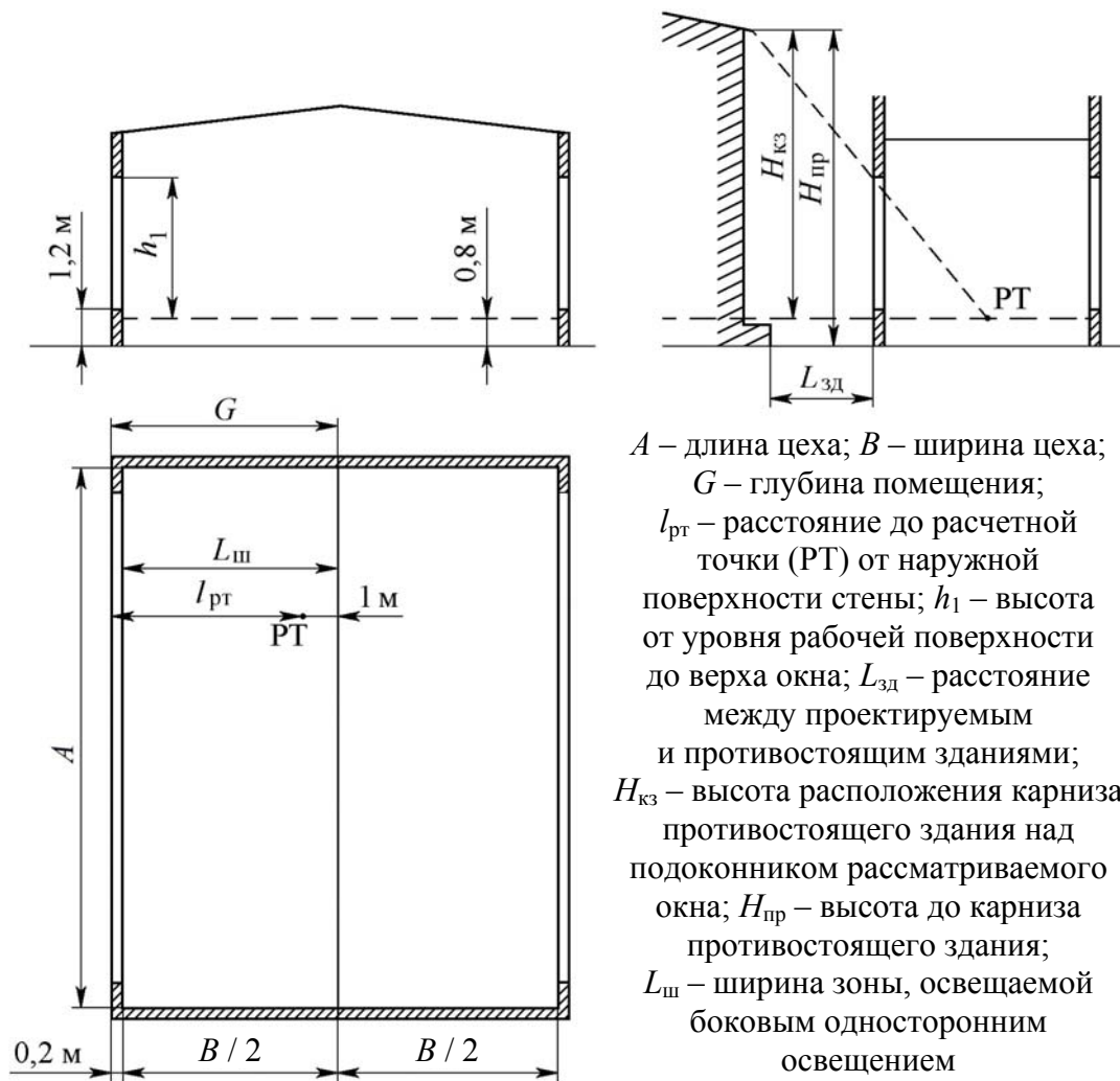
Рис. 2. Схема для расчета бокового двухстороннего естественного освещения
