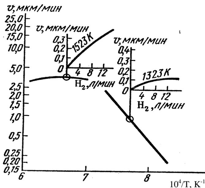
Рис. 2. Температурная зависимость скорости роста эпитаксиального кремния в хлоридном методе.
