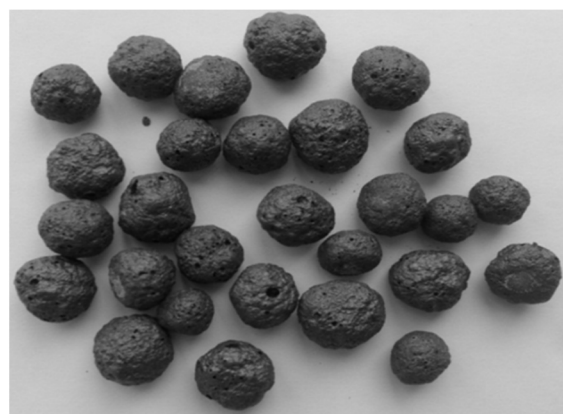
Рис. 5. Пористый заполнитель фракции 10–16 мм, полученный на основе керамической массы состава Г-3
