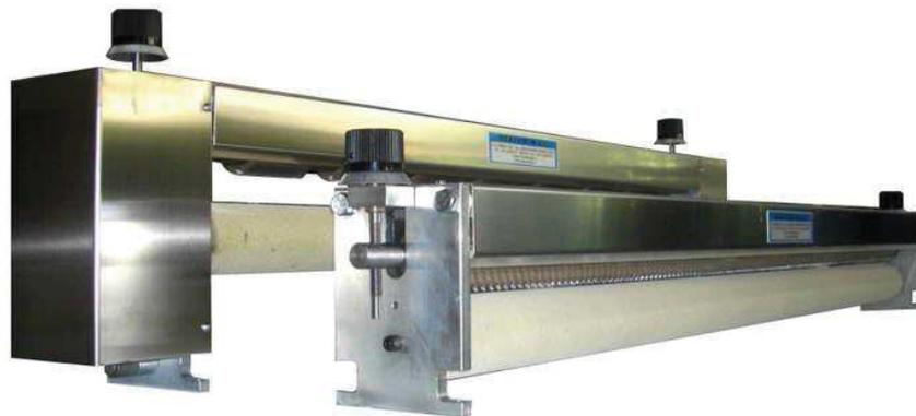
Рисунок 1 – Машина для холодной перфорации
