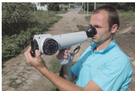
Рисунок 2 – Оценка интенсивности запаха полевым ольфактометром
