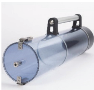
Рисунок 1 – Стандартное пробоотборное устройство для организованных источников
