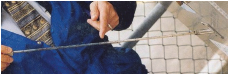
Рисунок 7 – Щуп для определения износа адсорбента
