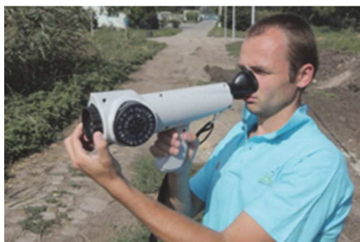
Рисунок 2 – Оценка интенсивности запаха полевым ольфактометром
