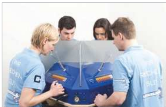
Рисунок 1 – Работа со стационарным ольфактометром
