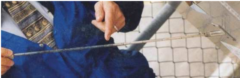
Рисунок 7 – Щуп для определения износа адсорбента
