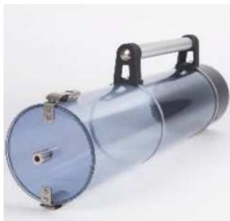
Рисунок 1 – Стандартное пробоотборное устройство для организованных источников
