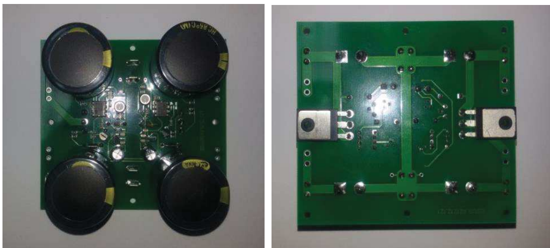
Рисунок 2 - Двуполярный стабилизатор напряжения программно-управляемого устройства для автоматизации процессов электроосаждения тонкопленочных материалов
