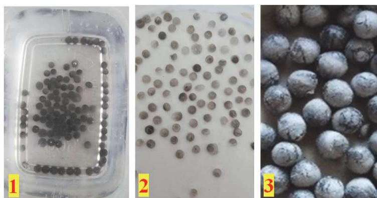
Рисунок 2 – Последовательный цикл обработки магнетитовых ядер: 1. В растворе полимеризатора (до сушки); 2. После сушки при температуре 100° (сушка); 3. После высокотемпературной обработки
