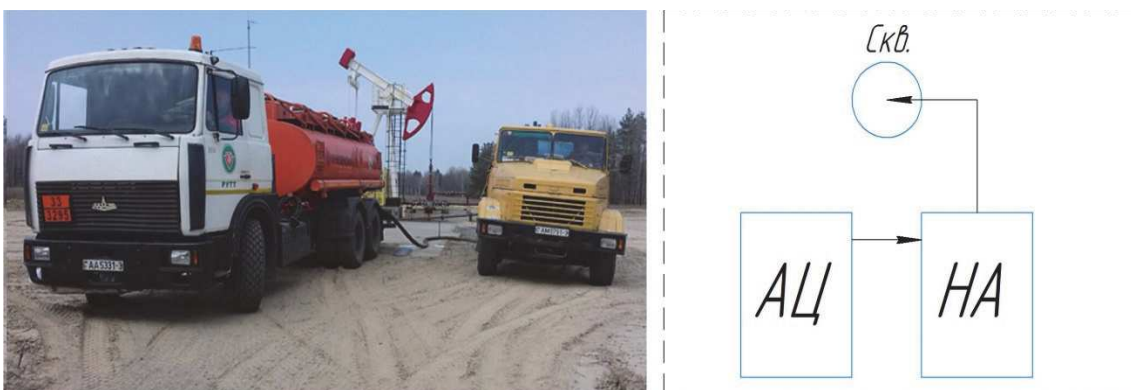
Рисунок 2 – Схема закачки пресной воды при помощи насосного агрегата (НА) и автоцистерны (АЦ)
