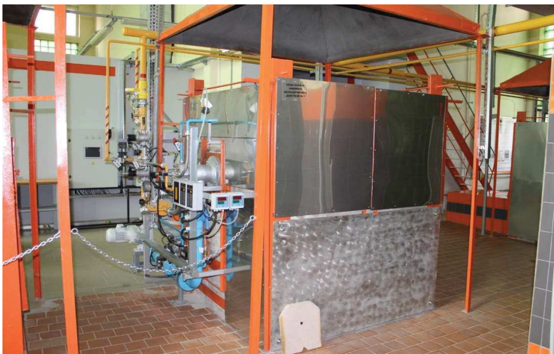
Газовая печи для варки стекол и обжига керамических материалов в лаборатории высокотемпературного синтеза кафедры технологии стекла и керамики
