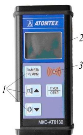
Рис. 1. МКС-АТ6130: 1 – мембранная панель управления; 2 – жидкокристаллический индикатор (ЖКИ); 3 – светодиодный индикатор
