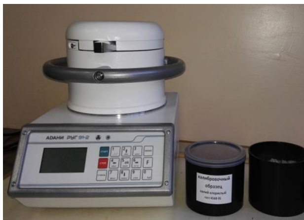
Рис. 2. Общий вид гамма-радиометра РУГ-91-2
