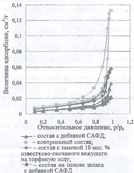
Рисунок 4 — Изотермы сорбции паров азота на исследуемых образцах ячеистого бетона
