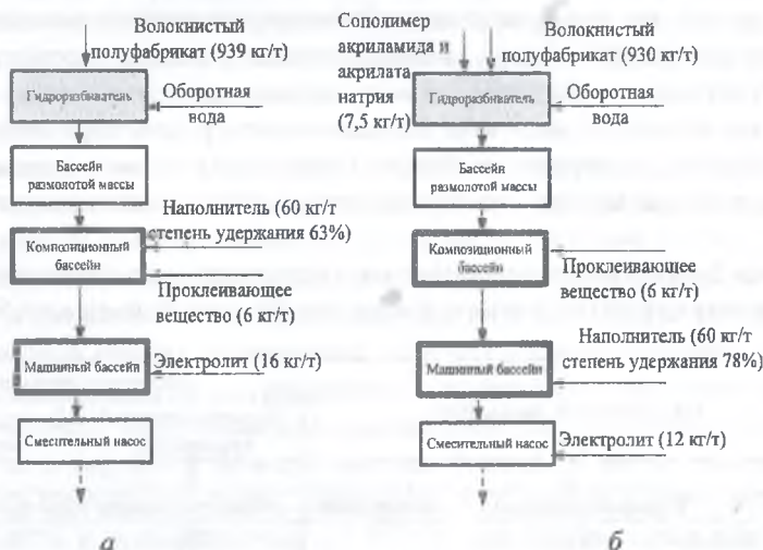
Рисунок 8 – Принципиальная блок-схема наполнения полиграфического картона по существующей (а) и разработанной (б) технологиям
