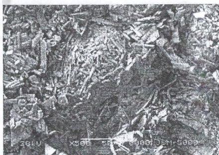
Рисунок 8 – Микроструктура полиминерального гипсового вяжущего, полученного методом химической дегидратации \text{CaSO}_4 \cdot 2\text{H}_2\text{O} при \times 500
