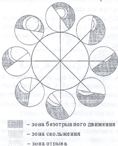
Рисунок 8 – Изменение границ помольных зон для планетарной мельницы с внешней обкаткой барабанов при k = 0,5 и \Omega = 4 рад/с
