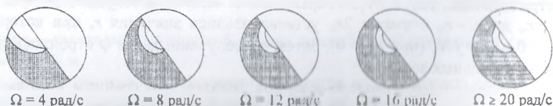
Рисунок 9 – Изменение границ помольных зон при внешней обкатке барабанов и k = 0,5 в зависимости от угловой скорости водила \Omega
