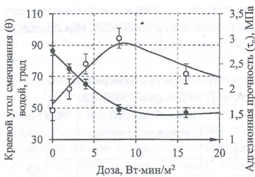
Рисунок 2 – Зависимость краевых углов смачивания (1) полиэтиленовой пленки водой и прочности адгезионных соединений (2) от дозы обработки коронным разрядом
