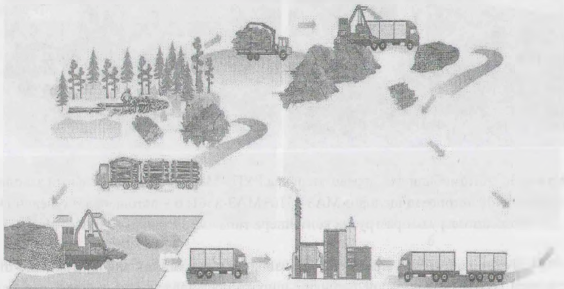
Рисунок 4 – Схема организации технологического процесса производства топливной щепы
