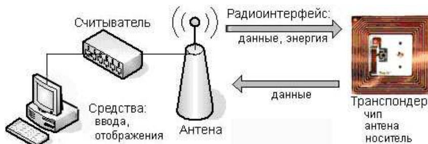
Рис. 3. Типичная структура и основные компоненты RFID-системы
