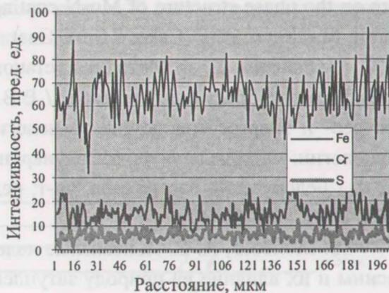
Рисунок 3 – РЭМ изображение поверхности (а) и распределение характеристического рентгеновского излучения Mo, Fe и Cr вдоль линии АВ (б) покрытия на S-основе изношенной режущей кромки резца
