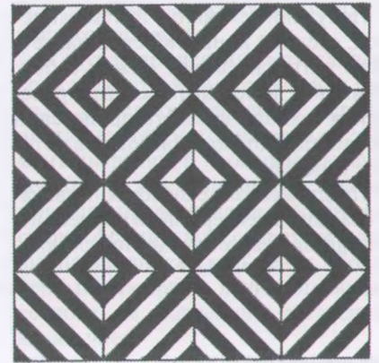
Рис. 2. Фрагмент паркетного пола, состоящий из 16 паркетных щитов
