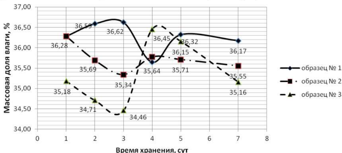
Рисунок 3 - Динамика значений массовой доли влаги во фруктовых наполнителях в процессе хранения при различных температурных режимах
