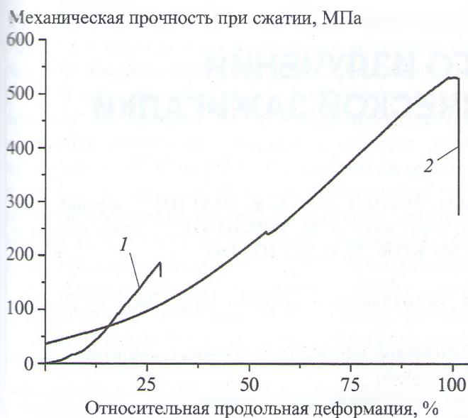
Рис. 4. Механическая прочность магнезиально-кварцевой керамики и стеклокерамики
