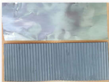
Рисунок 1 – а – гладкая фольга; б – гофрированная фольга
