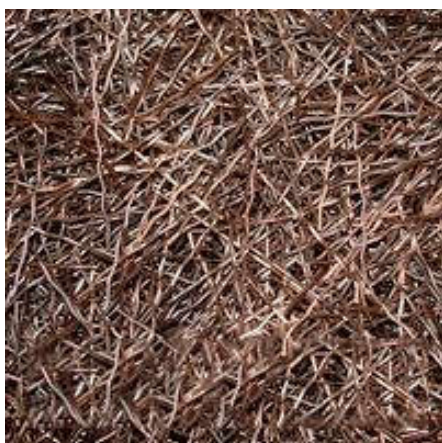
Рисунок 1 - Анкерная стальная фибра
