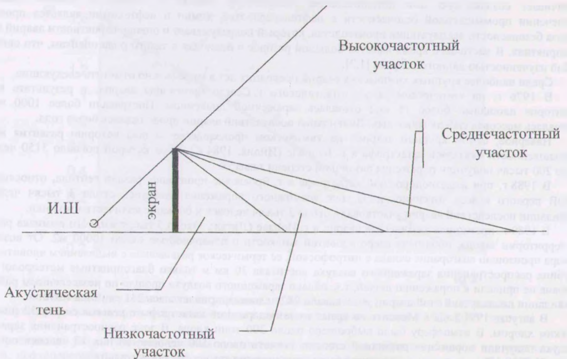
Рисунок 1 Формирование звуковой тени за экраном
