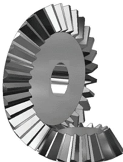
Рис. 4.1. Зубчатая коническая прямозубая передача
