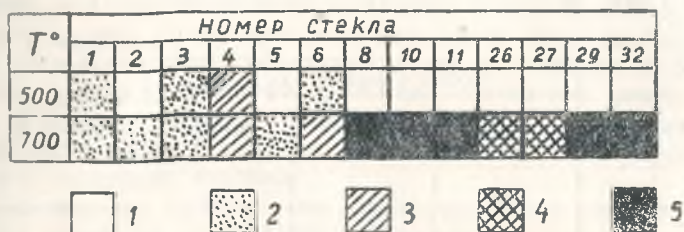
Рис. 2. Кристаллизационная способность стекла системы CaO—PbO—Al 2 O 3 . 1 — незакристаллизовавшееся стекло; 2 — начало кристаллизации; 3 — кристаллическая пленка; 4 — кристаллическая корка; 5 — полная кристаллизация.
