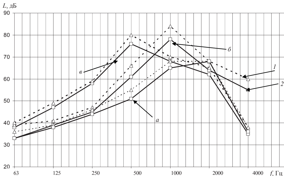
Рис. 4. Октавные спектры виброускорений конических колес на первой (а), второй (б) и третьей (в) передачах после 2700 моточасов: 1 – цементированные; 2 – упрочненные боросилицированием
