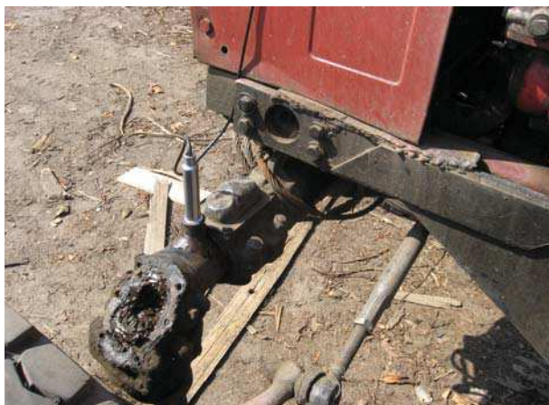
Рис. 2. Установление датчика для измерения виброускорений на передний ведущий мост трелевочного трактора
