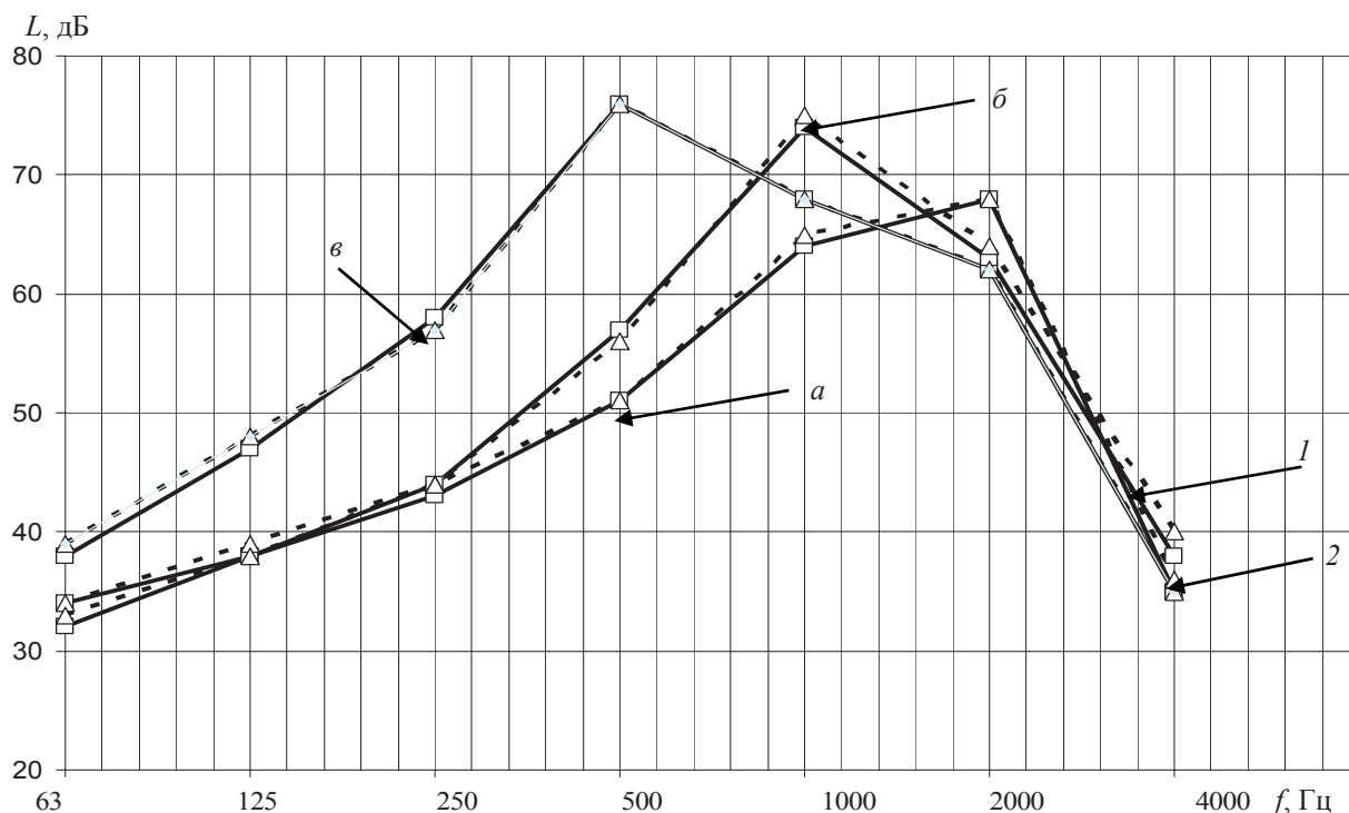
Рис. 3. Октавные спектры виброускорений конических колес на первой (а), второй (б) и третьей (в) передачах после 50 моточасов: 1 – цементированные; 2 – упрочненные боросилицированием
