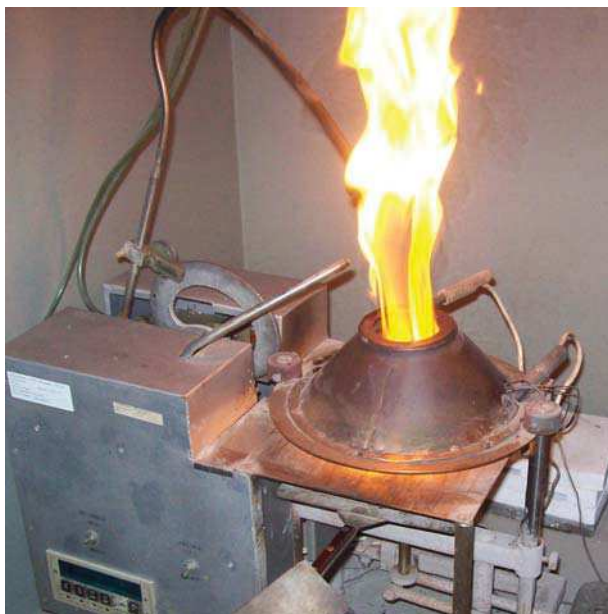
Рис. 3. Воспламеняемость ЛГМ под воздействием плотности лучистого теплового потока
