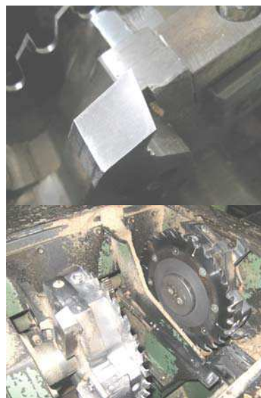
Рис. 6. Модернизированная фреза фрезерно-обрезного станка BSP-100 в процессе производственных испытаний
