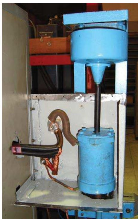
Рис. 7. Устройство для подачи шариков в индуктор
