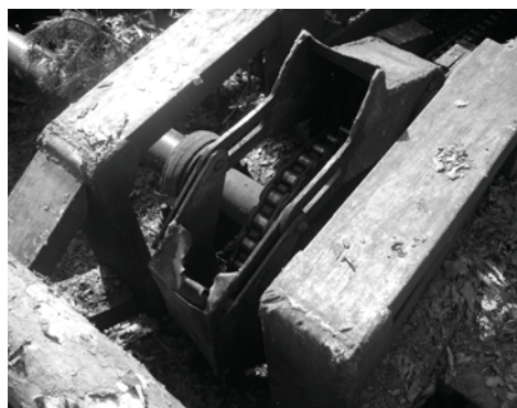
Рис. 3. Характер износа захватного механизма установок УППЗ
