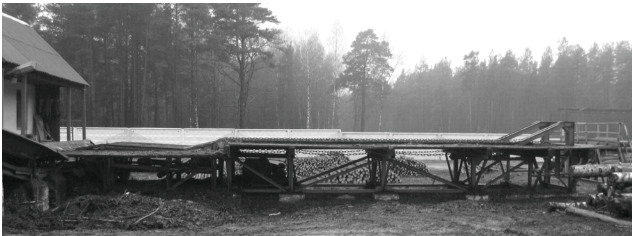
Рис. 2. Установка поштучной подачи круглых лесоматериалов УППЗ
