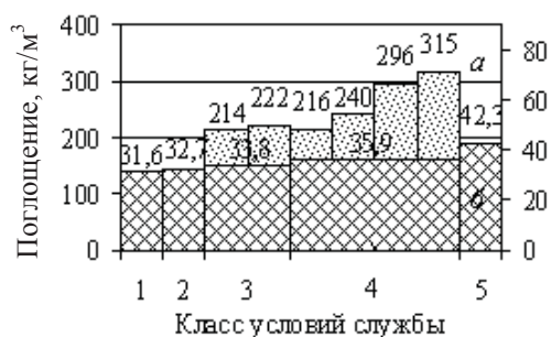
Рис. 2. Поглощение сланцевого масла в зависимости от класса условий службы: а – полученное в результате расчетов; б – экспериментально
