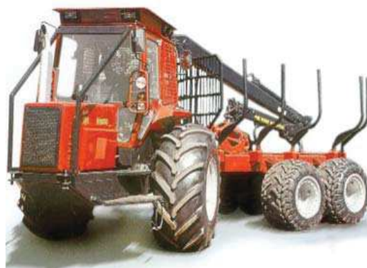
Рис. 2. Погрузочно-транспортная машина МЛ-131 «Беларус»
