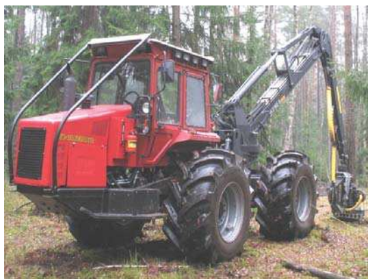
Рис. 1. Валочно-сучкорезно-раскряжевочная машина МЛХ-414 «Беларус»
