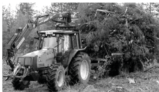
Рис. 1. Погрузочно-транспортные машины: а – форвардер; б – сельскохозяйственный трактор, оснащенный прицепной тележкой с гидроманипулятором
