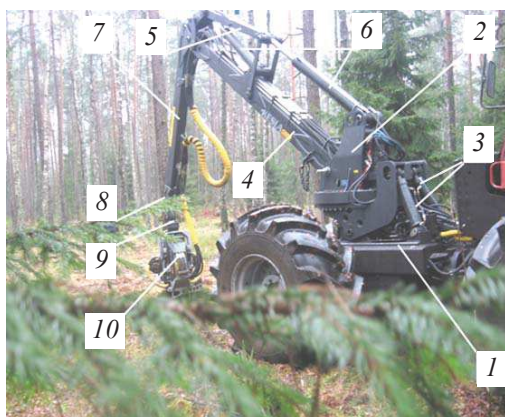
Рис. 2. Общий вид манипулятора Foresteri 1395H: 1 – опорная плита; 2 – колонна; 3 – гидроцилиндры; 4 – стрела; 5 – механизм совместного движения стрелы и рукояти; 6 – гидроцилиндры; 7 – рукоять; 8 – выдвижная секция; 9 – ротатор; 10 – харвестерная головка
