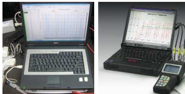
Рис. 4. Измерительная аппаратура: а – восьмиканальный многофункциональный измерительный усилитель «SPIDPAK» и портативный переносной компьютер; б – измерительный комплекс Parker и портативный компьютер
