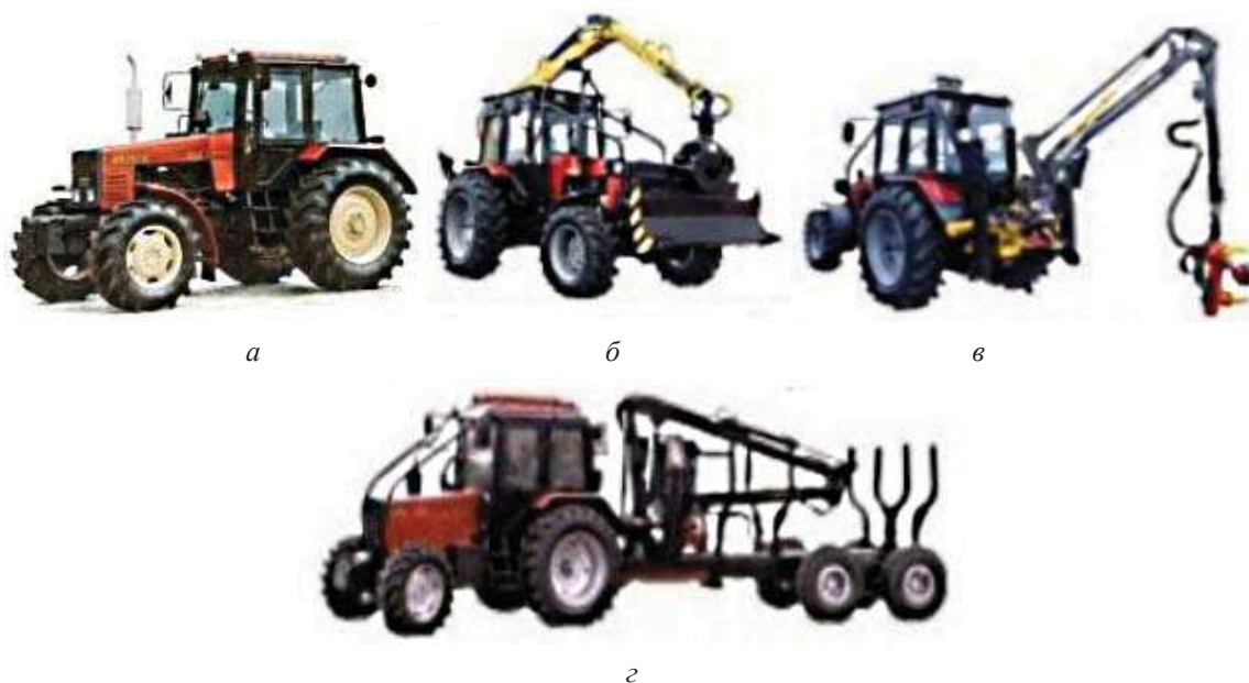
Рис. 1. Лесные машины с жесткой рамой на базе трактора МТЗ-Л122.1 (а); МПР-394 (б); МЛХ-401 (в); МПТ-471 (з)
