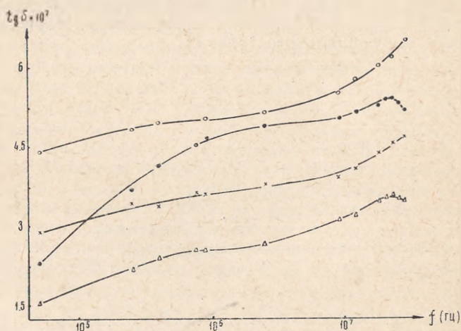
Рис. 2. Зависимость tg \delta от частоты электрического поля для естественной ( \Delta — тангенциальный срез, \bullet — торцевой срез) и модифицированной ( \times — тангенциальный срез, \circ — торцевой срез) древесины березы.
