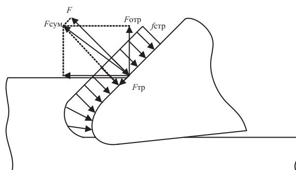
Рис. 1. Силы резания по передней поверхности резца
