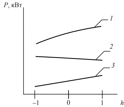
Рис. 5. Влияние высоты срезаемого слоя на мощность резания
