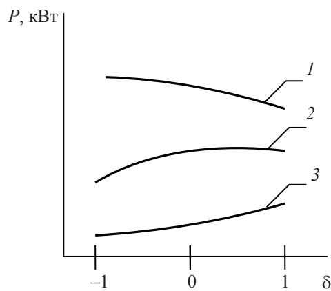
Рис. 4. Влияние угла заострения на мощность резания
