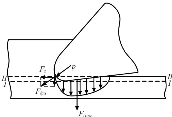
Рис. 2. Силы резания по задней поверхности резца
