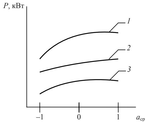
Рис. 3. Влияние средней толщины стружки на мощность резания
