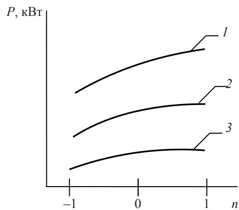
Рис. 6. Влияние частоты вращения инструмента на мощность резания
