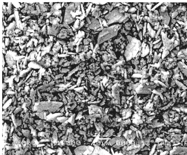
Рис. 2. Микрофотография образца 2, полученного в системе Al_2(SO_4)_3-CaCO_3-NaOH-Na_2CO_3-H_2O
