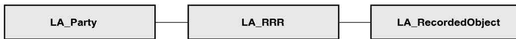
Рис. 2. Ключевые классы LADM: класс LA_Party — субъекты гражданского права, класс LA_RRR — правоотношения, LA_RecordedObject — зарегистрированный объект недвижимости
