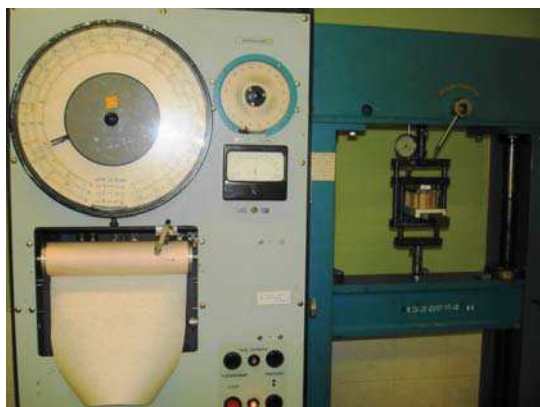
Рис. 1. Схема испытания бумажного сотового наполнителя на сжатие
