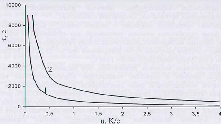
Рис. 2 – Зависимость времени образования кремнийсодержащих соединений от скорости нагрева образцов
