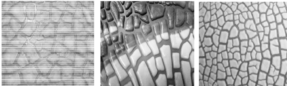
Рис. 1. Синтезированные глазурные покрытия кракле
