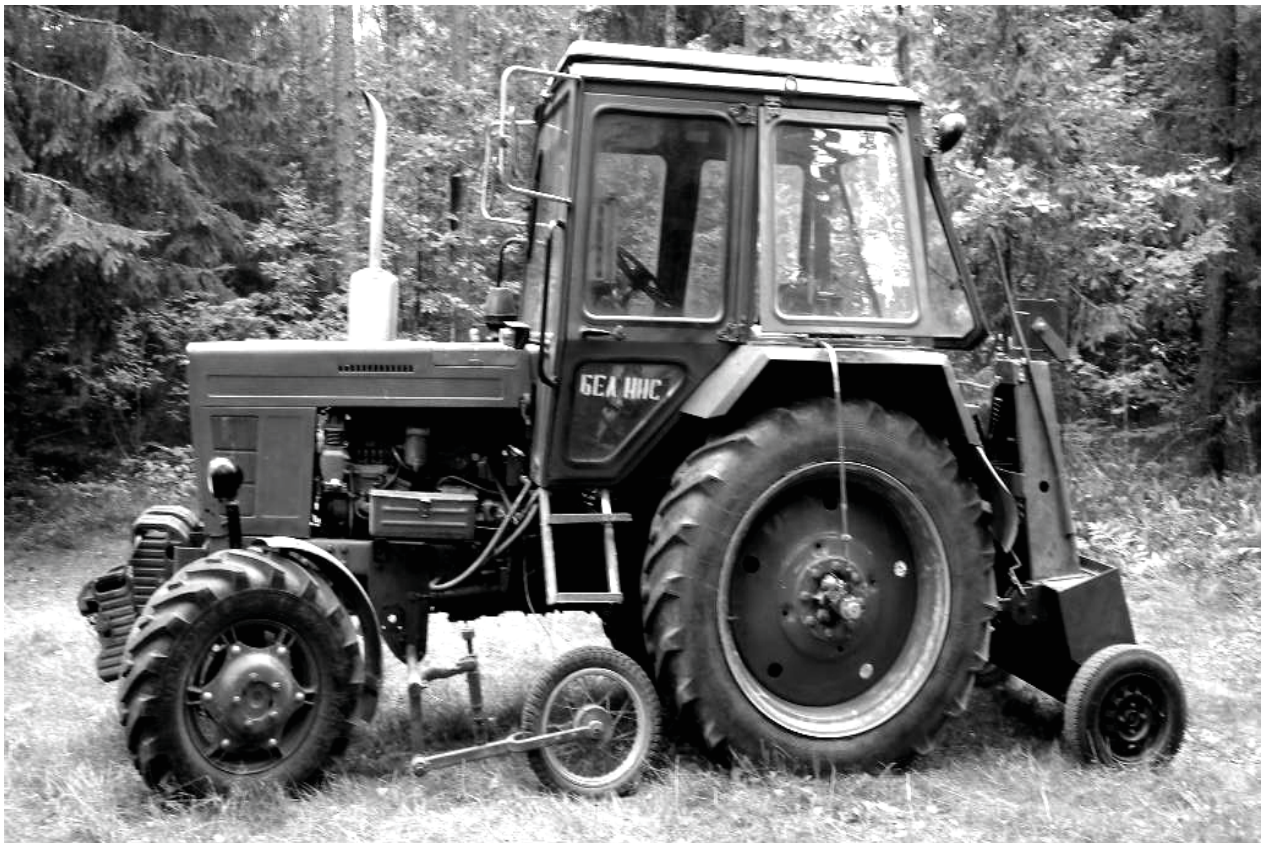
Рис. 1. Переоборудованный трелевочный трактор ТТР-401
