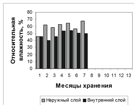
Рис. 8. Изменение влажности щепы из отходов лесозаготовок
