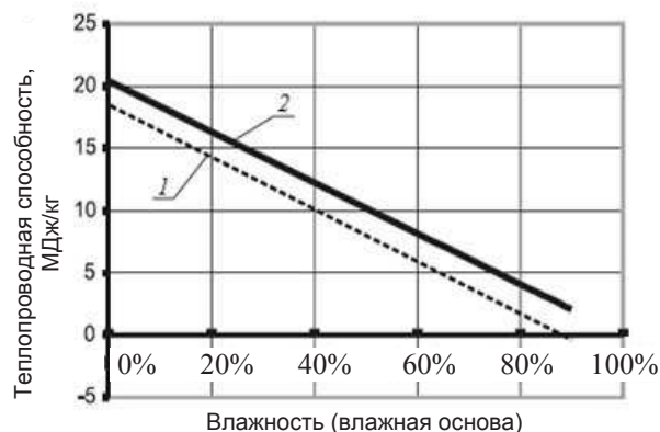
Рис. 6. Воздействие влажности на величину теплоты сгорания древесины 1 – низшая теплота сгорания; 2 – высшая теплота сгорания
